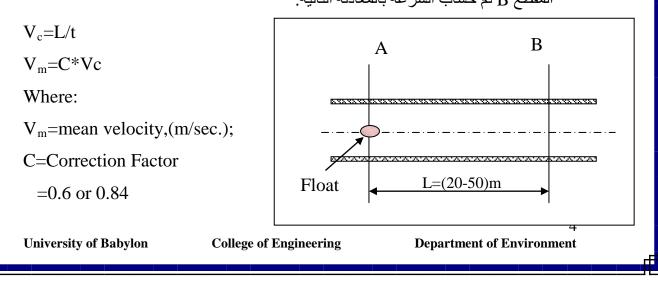
هذه الطريقة ادق من الطريقة السابقة لأن الـ (Rods) سيقيس الـ(mean velocity)
